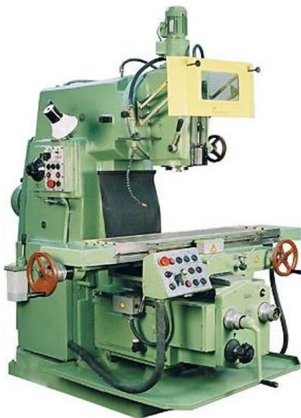
Рисунок 2 – Вертикально-фрезерный станок 6P12
