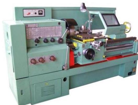
Рисунок 3 – Токарно-винторезный станок модели 16К20
